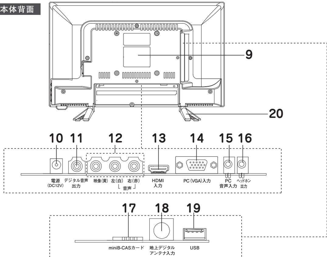
**9** 壁掛け金具取り付けネジ穴×4
