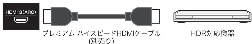
HDR対応機器との接続には、18Gbpsに対応したプレミアムハイスピードHDMIケーブルを使用してください。
